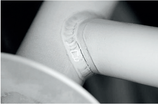
Falsch: Riss in der Wärmeeinflusszone der Schweißnaht an einem Rohrknotenpunkt.
