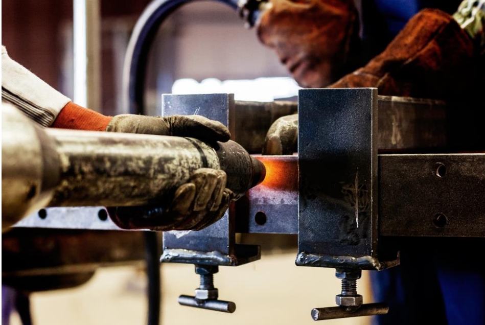
...dann wird der Kopf zum Schließkopf geformt.
