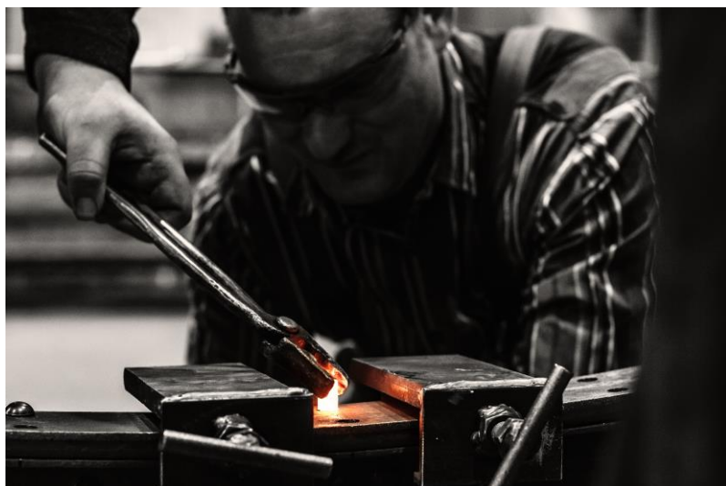
Beim Nietvorgang wird der glühende Niet durch die Bauteile hindurchgesteckt...
