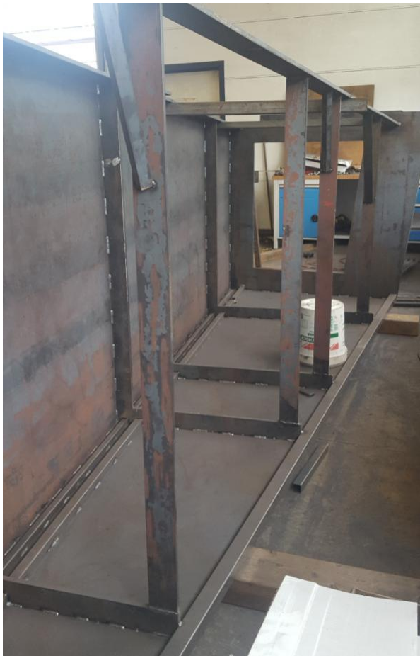
Aus Gründen des Korrosionsschutzes mussten abschließend auch die Aussteifungsrippen durchgehend verschweißt werden.
