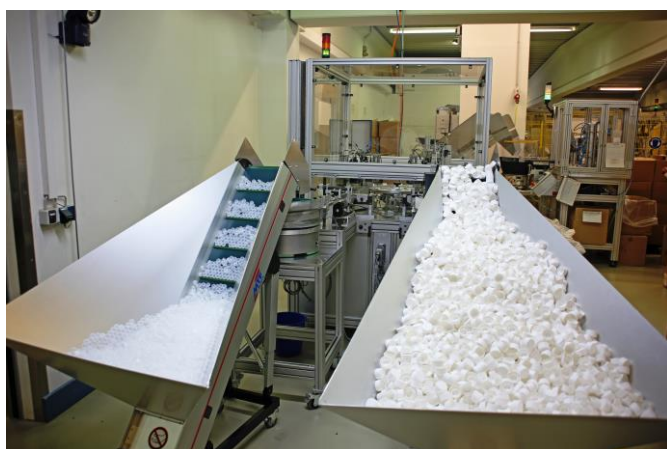
So sieht eine „klassische“ automatisierte Montage von Außen- und Innendeckel nach separater werkzeugfallender Produktion aus. Foto: Klaus Vollrath
