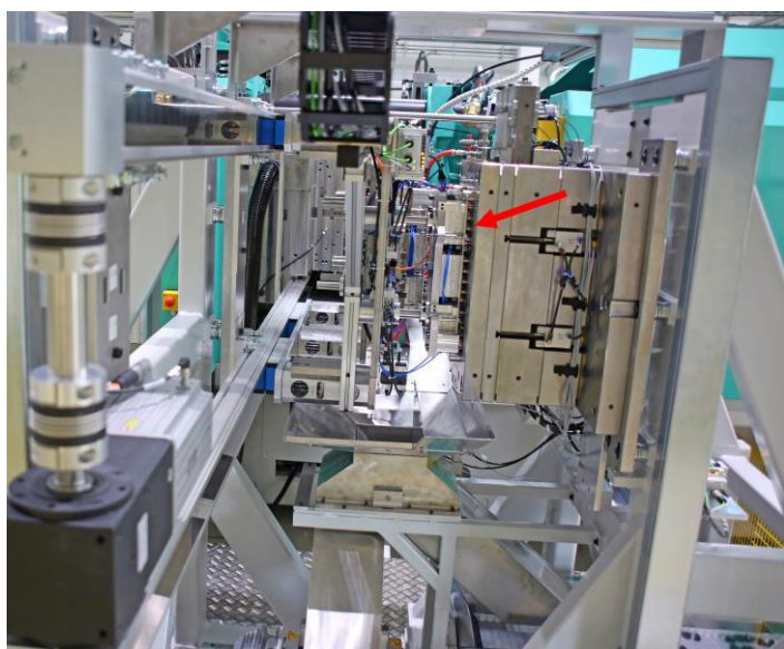
Übergabe der schwarzen Außenkappen (Pfeil) vom Entnahmewerkzeug nach rechts an die Montage- und Prüfstation. Foto: Klaus Vollrath
