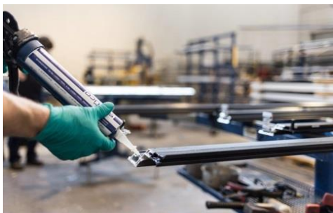
Vorbereitung für die Verklebung des Blendrahmens mit dem speziellen Gehrungsklebstoff.
