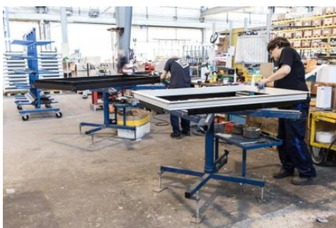
Vorbereitungsarbeiten: links ein Blendrahmen, rechts ein Flügel.
