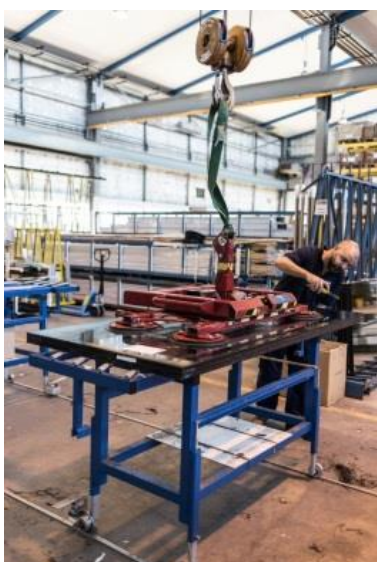
Die geprüften und gereinigten Gläser werden mit der Sauganlage angehoben.
