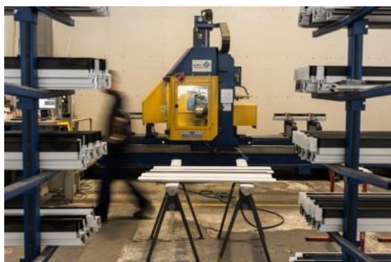
Die Profilbearbeitung erfolgte im Werk der Surber Metallbau auf dem Bearbeitungszentrum von Schüco. Foto: Schüco International
