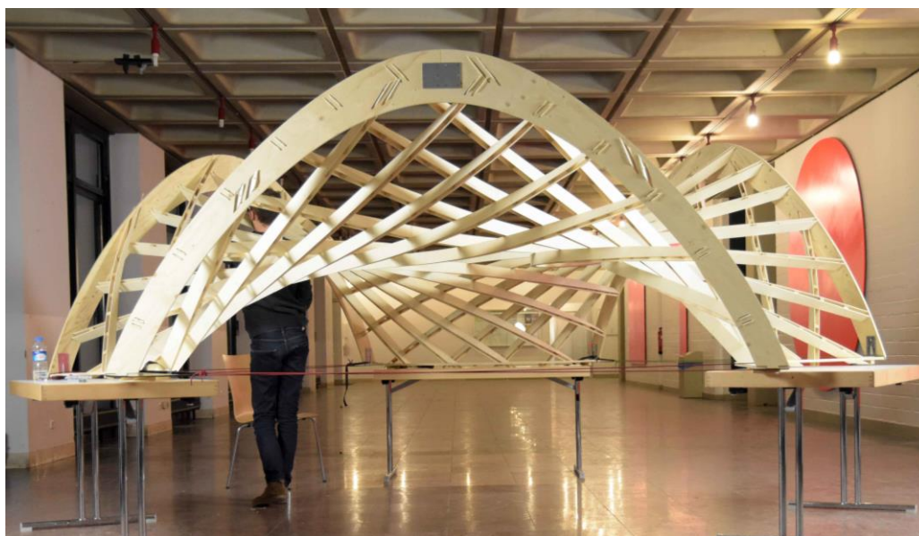
Zuerst wurde ein Prototyp aus drei Millimeter dicken Holzlamellen gebaut. Die beiden Scharen verlaufen in zwei Ebenen und sind durch Quadratbolzen miteinander gekoppelt. Foto: Eike Schling
