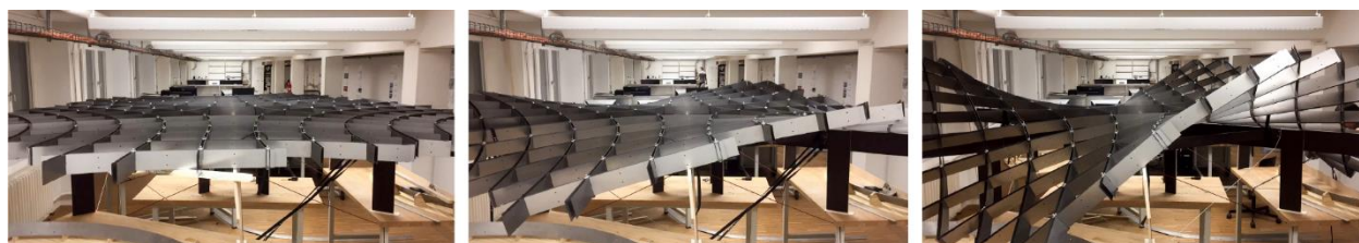
Der zweite Prototyp wurde aus 1,5 Millimeter dicken Blechstreifen gesteckt. Hierbei wurde das erste Mal „Bottom-Up“ Aufbauprozess angewandt, in dem das Gesamte Modell in seine dreidimensional Form gebogen wird. Foto: Eike Schling
