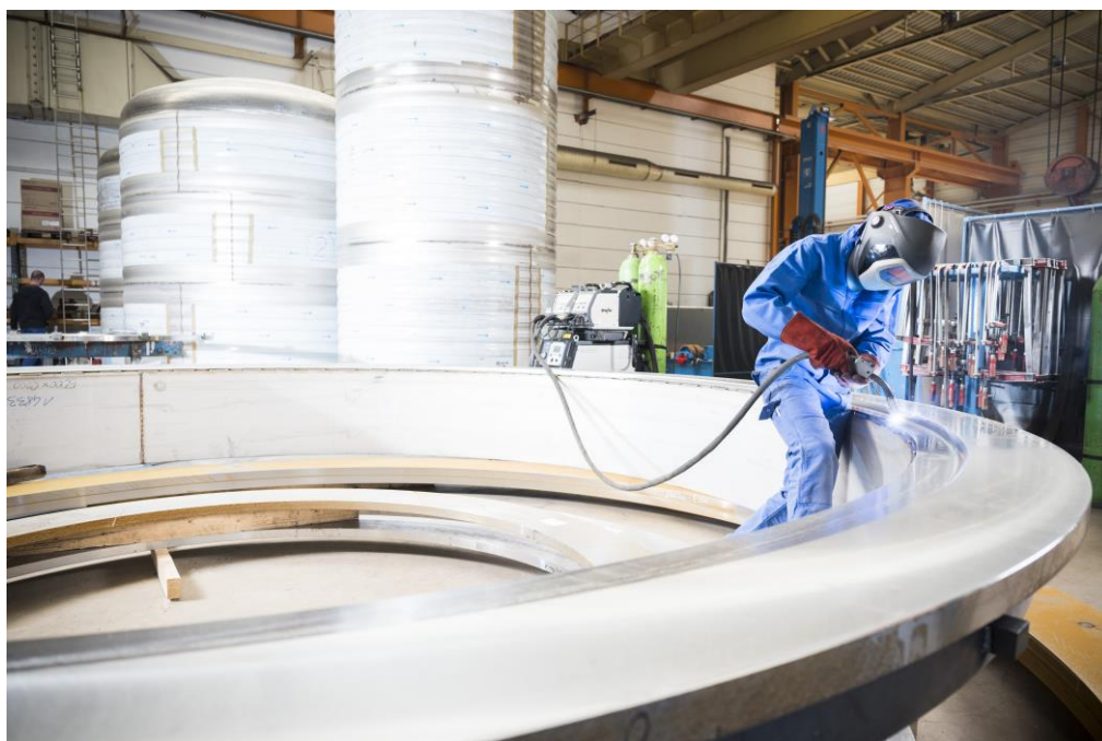
Schwarz/weiß-Verbindung eines Schutzhauben-Flansches. Foto: EWM
