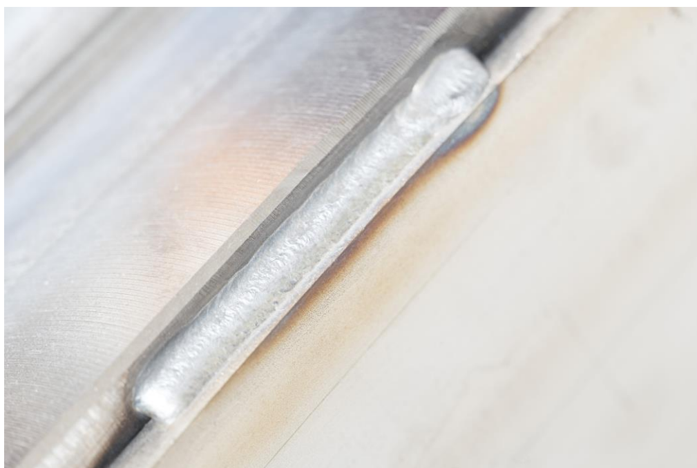
Die MAG-geschweißte Kehlnaht in PB ist nahezu spritzerfrei. Foto: EWM
