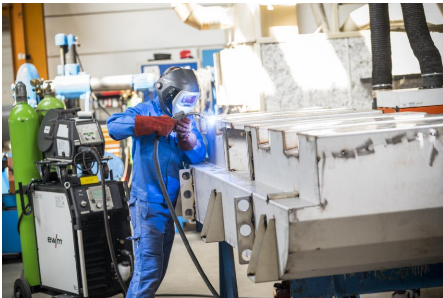
Nahezu spritzerfreies Schweißen der Eck-, Kehl- und Stumpfnähte an einem Düsenkasten von einem Anlassofen. Das wärmereduzierte Cold-Arc-Verfahren minimiert den Verzug beim Fügen der zwei Millimeter dicken Edelstahlbleche. Foto: EWM
