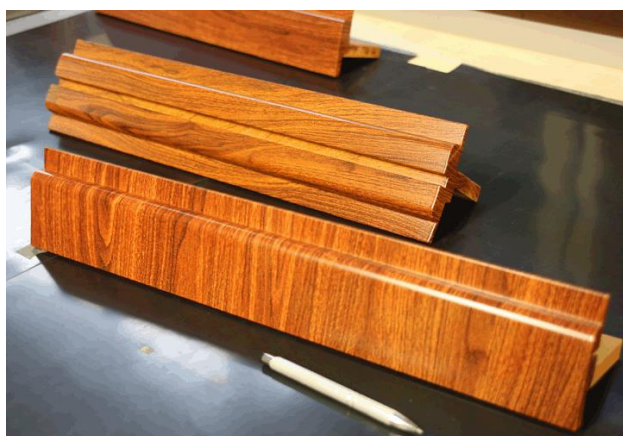
Noch im Experimentierstadium ist derzeit der Wassertransferdruck, mit dem Metalle mit hochwertigen, fest haftenden Dekoren zum Beispiel im Holzlook veredelt werden können.
