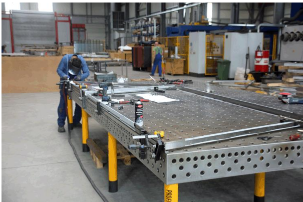
Ausführung von Schweißarbeiten an Fensterrahmen aus Duplex-Edelstahl.
