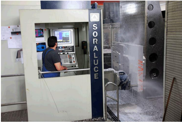
Wenn die 45-Kilowatt-Spindel mit 1.000 Newtonmeter Drehmoment ins Material fährt, entsteht ein regelrechter Späneregen. Fotos: Klaus Vollrath
