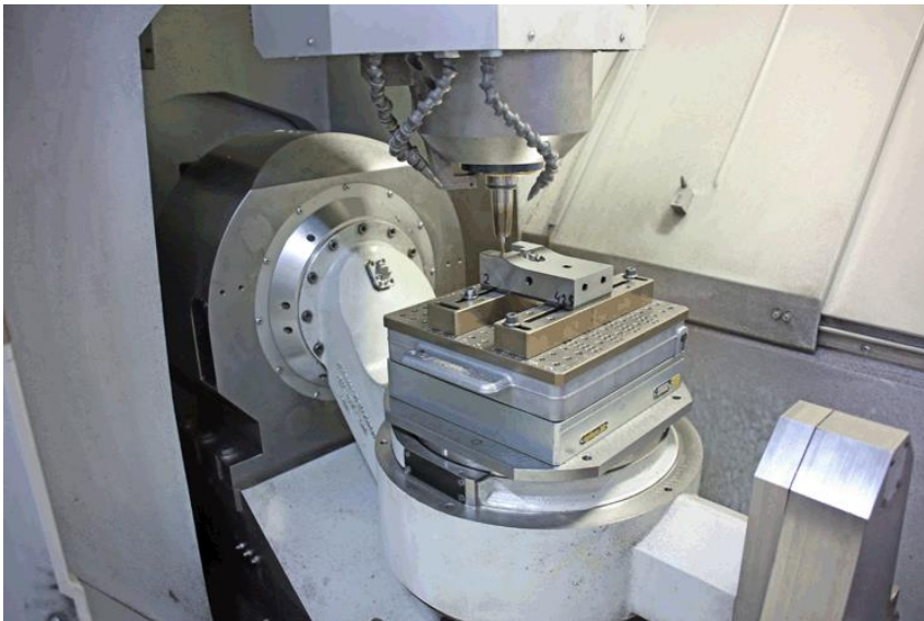
Der Arbeitsraum der RXP 601 DSH. In der Mitte der robuste, beidseitig gelagerte Dreh-Schwenktisch, das Gegenlager auf der rechten Seite weist eine Tragzahl von 7.000 Kilogramm auf. Foto: Klaus Vollrath
