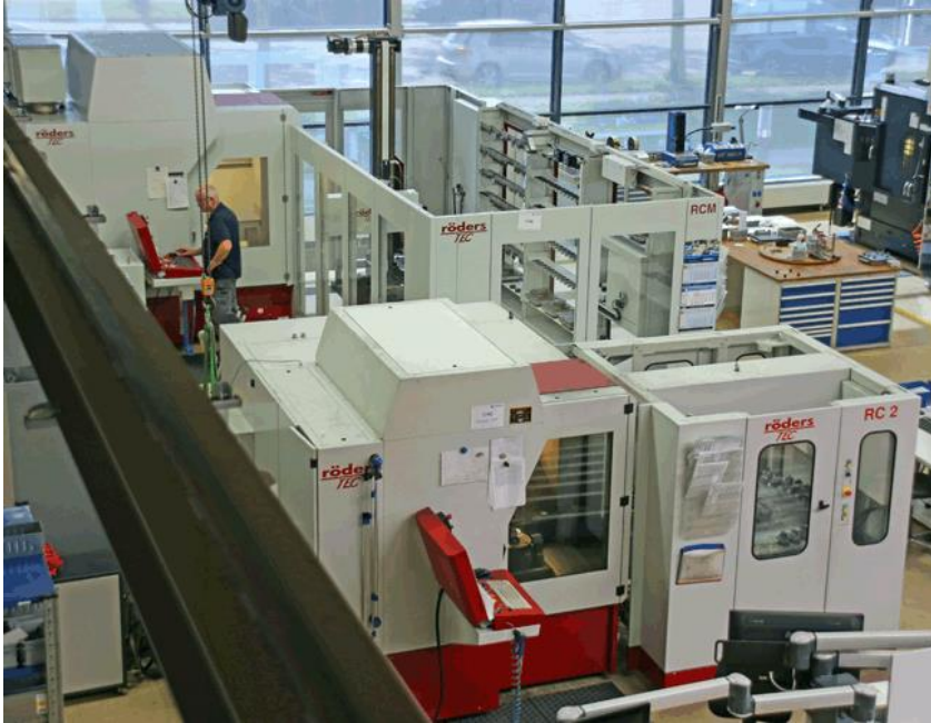
Die beiden automatisierten Rödgers-Fertigungszellen. Vorne eine RXP 500 DS mit RC 2 Karussellmagazin, hinten eine RXP 601 DSH mit erweiterbarem RCM Linearmagazin für Werkstücke und Werkzeuge. Foto: Klaus Vollrath
