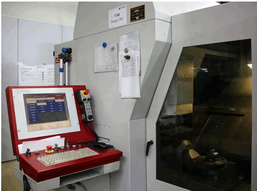
Die Röders-Steuerung RMS6 basiert auf dem Windows-Betriebssystem und lässt sich leicht und intuitiv bedienen. Hard- und Software können problemlos auf den jeweils neuesten Stand gebracht werden. Foto: Klaus Vollrath
