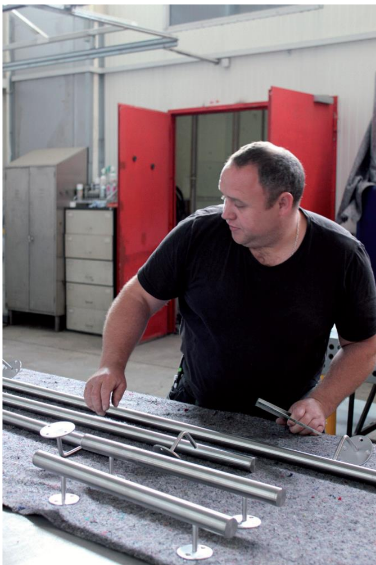
Auftragsabhängig werden die Oberflächen der Edelstahl-Abschnitte noch geschliffen.
