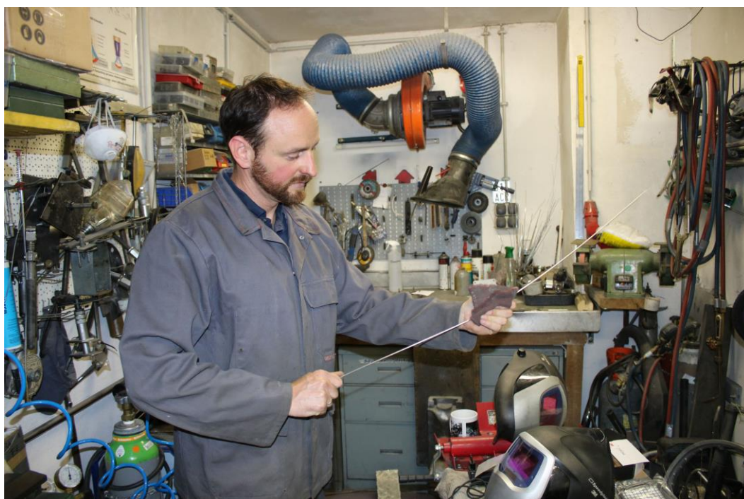
Auch die Elektrode und der zu verwendende Schweißdraht aus Aluminium müssen vor jedem Schweißvorgang gründlich geputzt werden.
