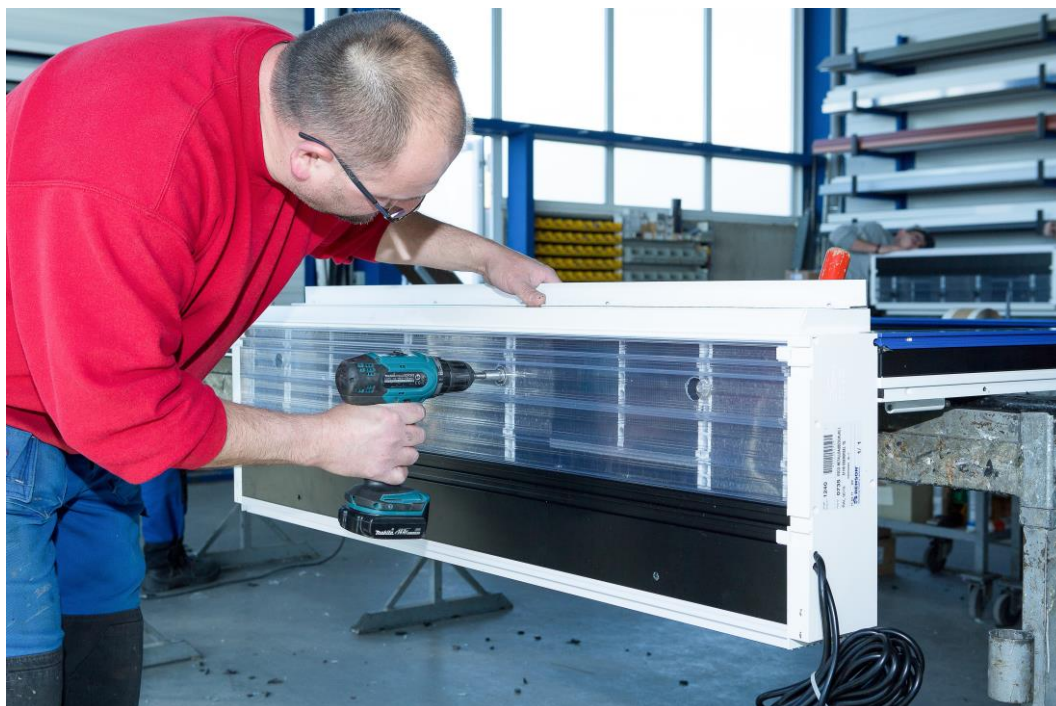
Verschrauben durch die gelochten Stege hindurch mit dem Fensterrahmen.
