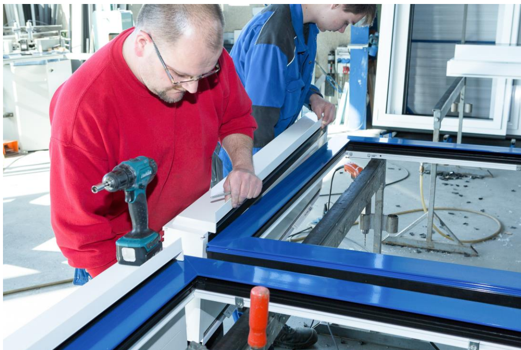
Aufsetzen der Endura Twist auf den Aluminium-Fensterrahmen. Fotos: Renson
