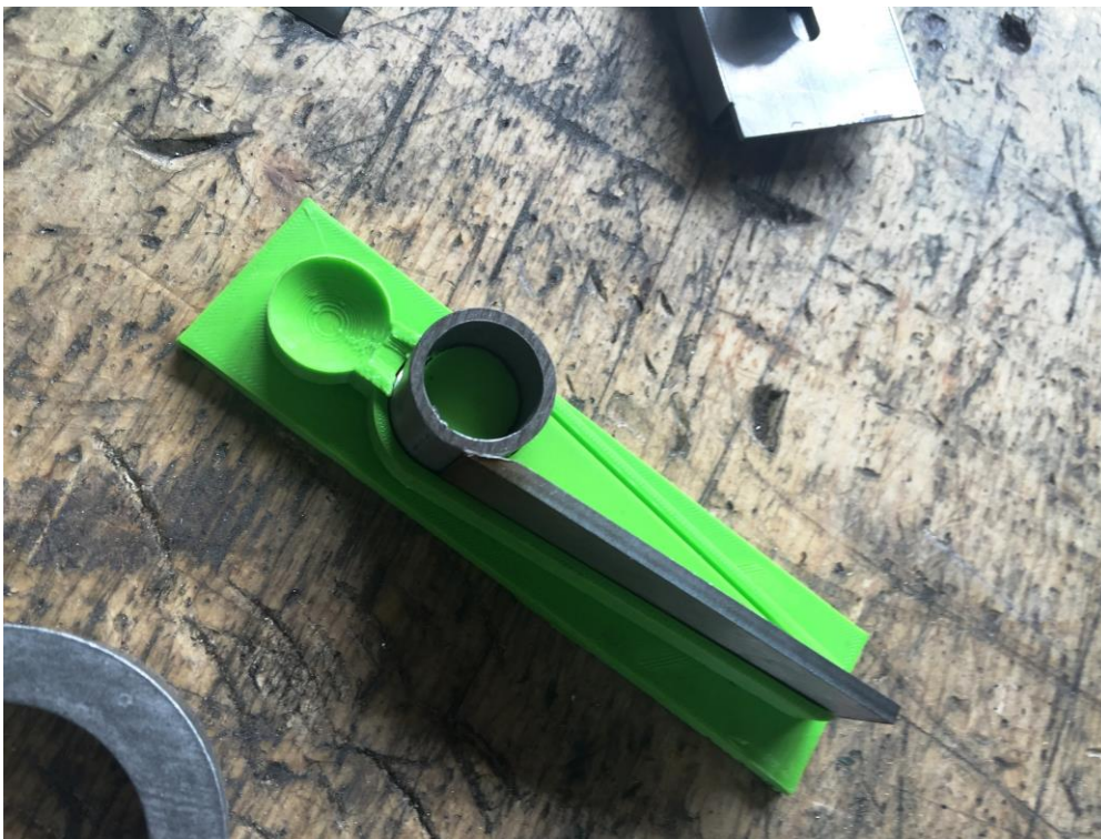
Die Vorrichtungen wurden im 3D-Druck gefertigt.
