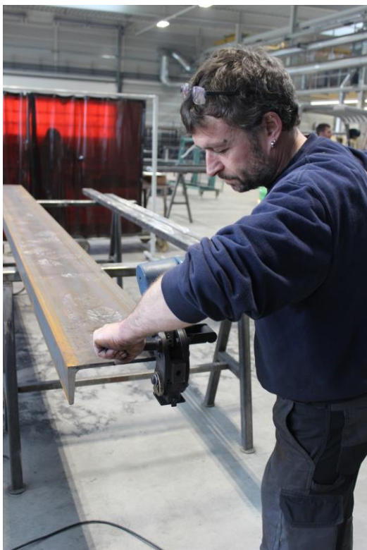
Mehr als 95 Prozent aller Schweißkanten erzeugen die Facharbeiter bei Markus Kalb mit dem Schweißkantenformer Tru-Tool TKF 1500.
