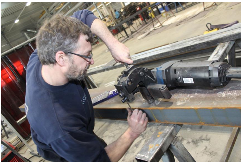
Andreas Mostögl, Schweißfachmann bei der Firma Markus Kalb, bereitet seinen Schweißkantenformer Tru-Tool TKF 1500 für den Einsatz vor. Es müssen lediglich Schrägungswinkel, Fasenlänge und Blechdicke eingestellt werden, wofür er weniger als einer Minute benötigt. Fotos: TRUMPF
