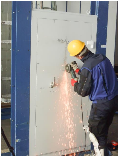
Einbruchttest in der höchsten Schutzklasse RC6 mit elektrischen Werkzeugen, zum Beispiel Winkelschleifer getestet.
