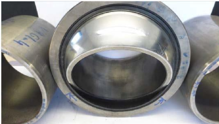
Im statischen Versuch wurde das Radial-Gelenklager bis 7.450 Kilonewton und die beiden Buchsen jeweils bis 3.725 Kilonewton belastet.
