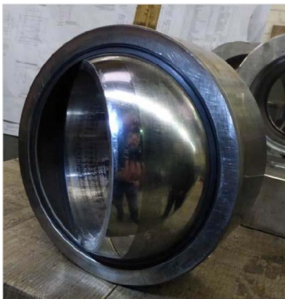
Radial-Gelenklager aus einem Versuchskörper im gedrehten Zustand.
