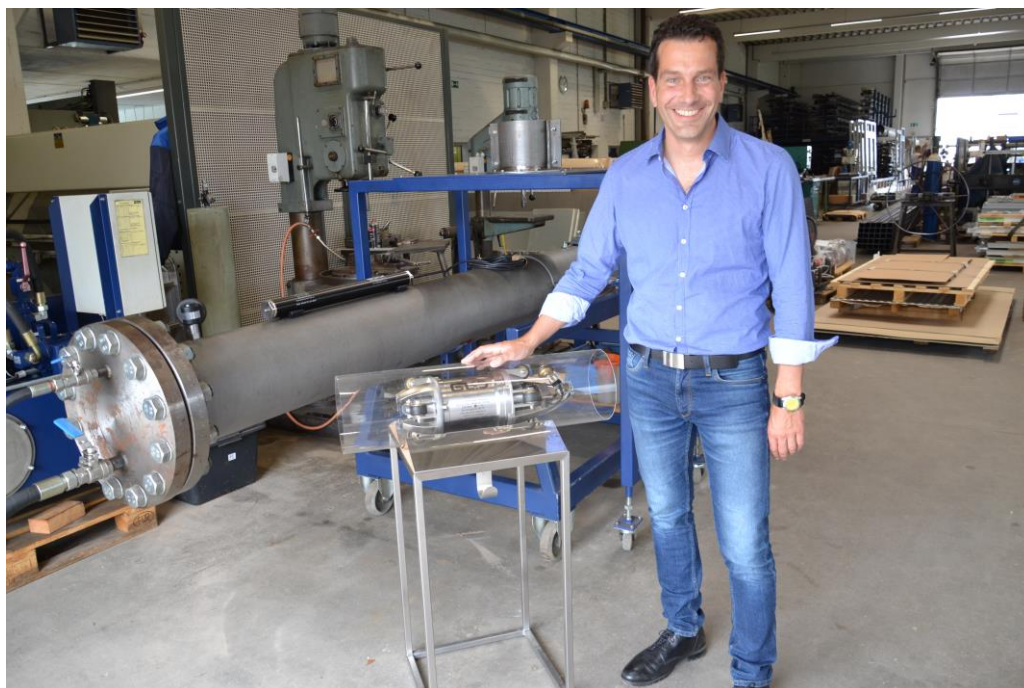
Firmenchef Ulf Gottsberg ist stolz auf die Entwicklung: Mit dem „Lecksuchmolch“ können kleinste Leckagen an Rohrleitungen identifiziert werden. Fotos: M&T
