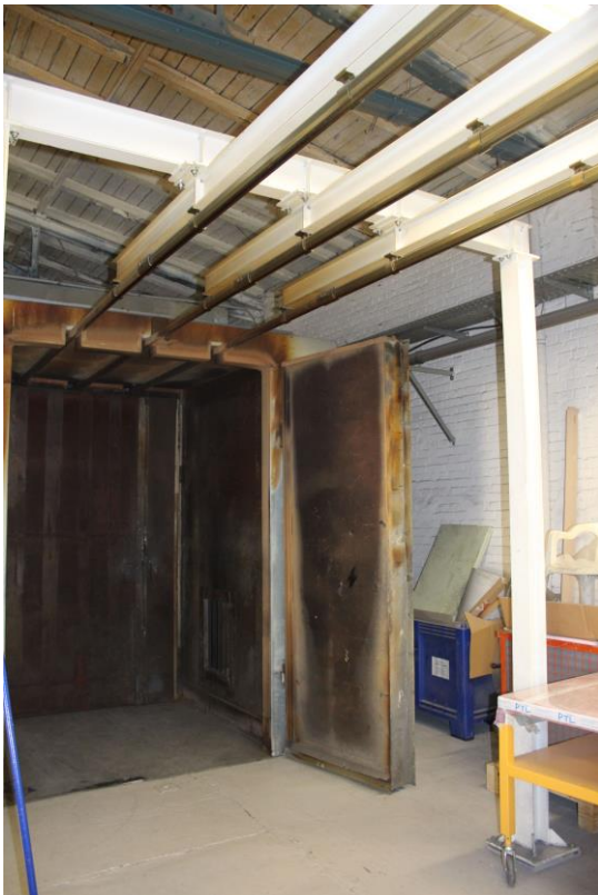
Im Einbrennofen erhält die Beschichtung anschließend für zwanzig bis dreißig Minuten ihr Finish. Darin verschmilzt die Pulverschicht bei entsprechenden Temperaturen zu einer fest vernetzten Lackschicht – eine widerstandsfähige Oberfläche entsteht.
