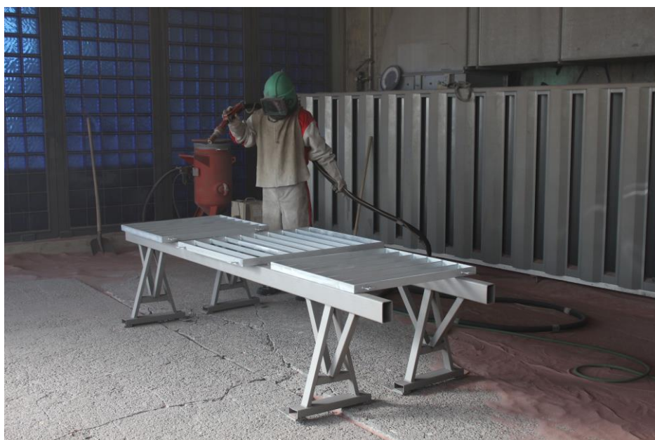
In der Strahlerei werden die Bauteile individuell gesweept. Fotos: Domke
