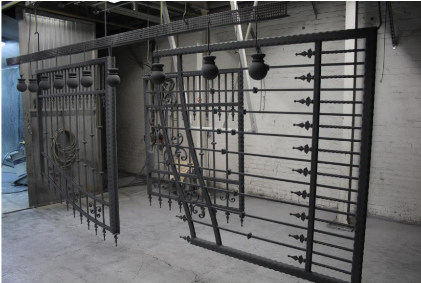
Die Gestelle mit den pulverbedeckten Werkstücken gelangen anschließend über die Förderanlage in den Pulverkammereinbrennofen.
