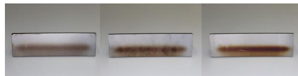
Bild 8: Vergleich der Anlauffarben unterseitig; links „forceArc puls“; Mitte „forceArc“; rechts Impuls
