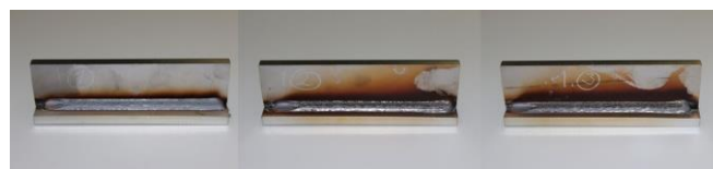
Bild 7: Vergleich des Nahtaussehens und der Anlauffarben, Blech t = 10 mm, DV = 13 m/min; links „forceArc puls“; Mitte „forceArc“; rechts Impuls magnetisiertes und entmagnetisiertes Rohr
