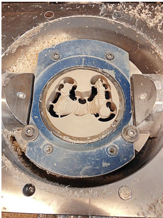
Testbearbeitung einer Zahnbrücke mit Ingersoll Plendur-Werkzeugen.
