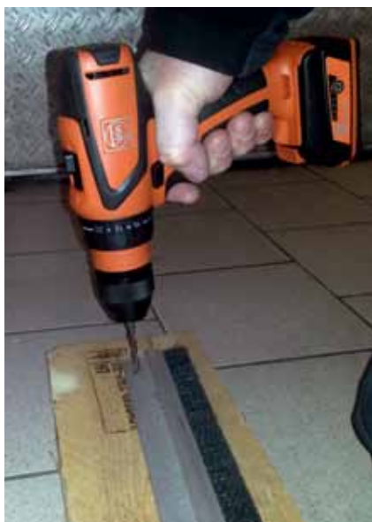
Der Vier-Gang-Akku-Bohrschrauber ASCM 12 C wurde beim Test auch für die Montage von Bürstendichtungen eingesetzt.
