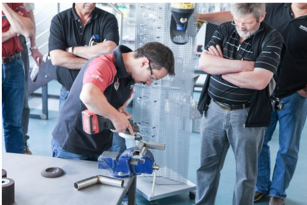
Die Praxis macht's: Seminarleiter Hilsenbeck demonstriert, wie man Edelstahl als Profi richtig grob- und feinschleift, poliert, satiniert, entgratet, Anlauffarben entfernt und Schweißnähte verschleift.
