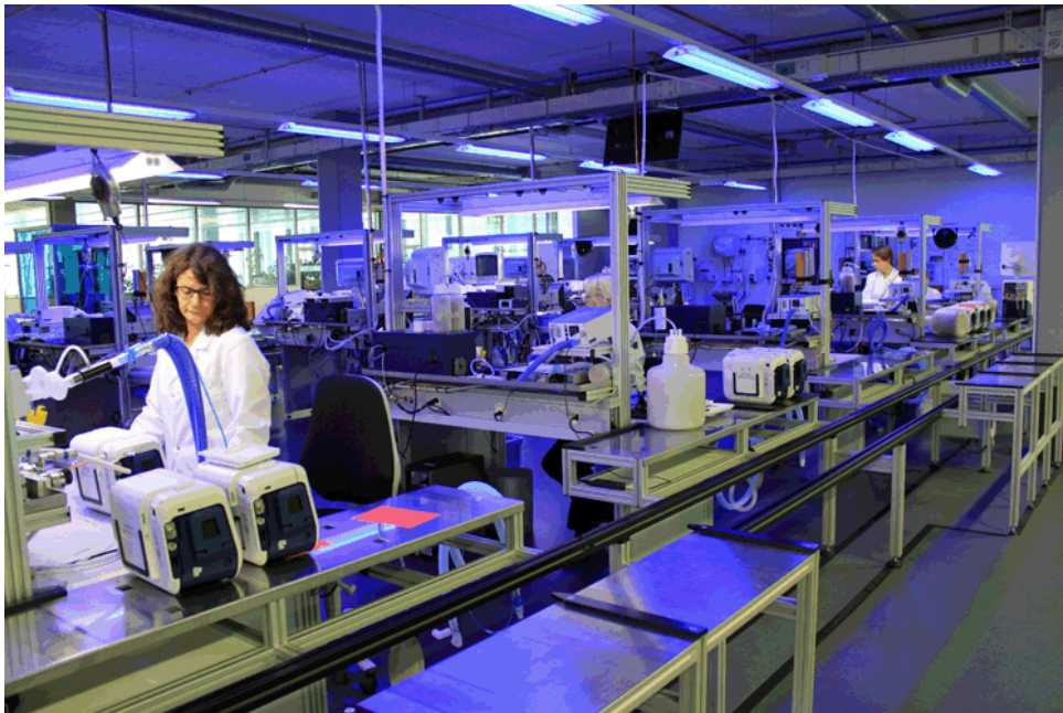
Hamilton ist in verschiedenen Bereichen der Medizintechnik Technologie- und Weltmarktführer. Hier werden Beatmungsautomaten montiert.
