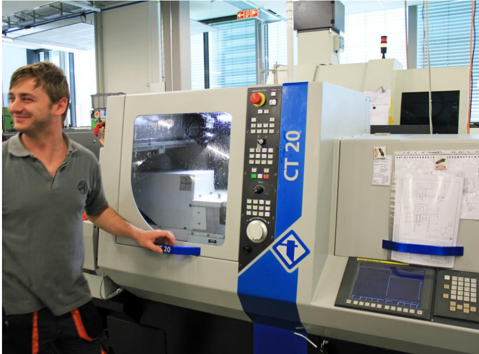
Schulung eines rumänischen Mitarbeiters am neuen Drehautomaten Tornos CT 20. Fotos: Klaus Vollrath
