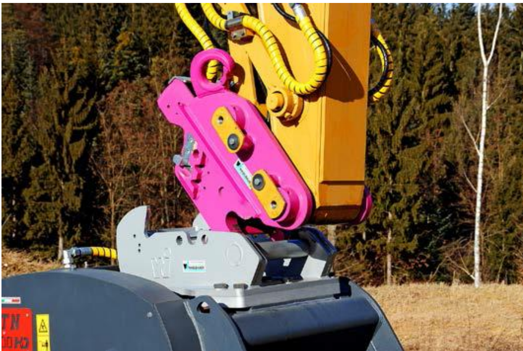
Schnellwechselsystem mit an der Baggerschaufel befestigtem Adapter.
