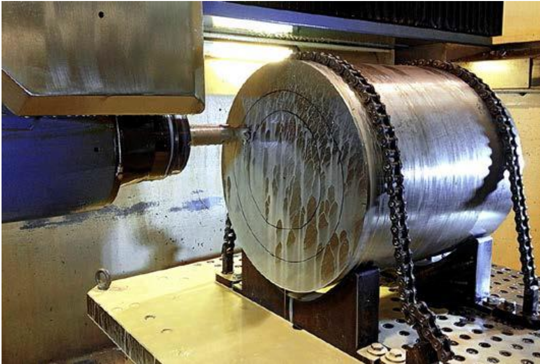
Bearbeitung der Spule für Laboranlage mit Ingersoll Hochvorschubfräser.
