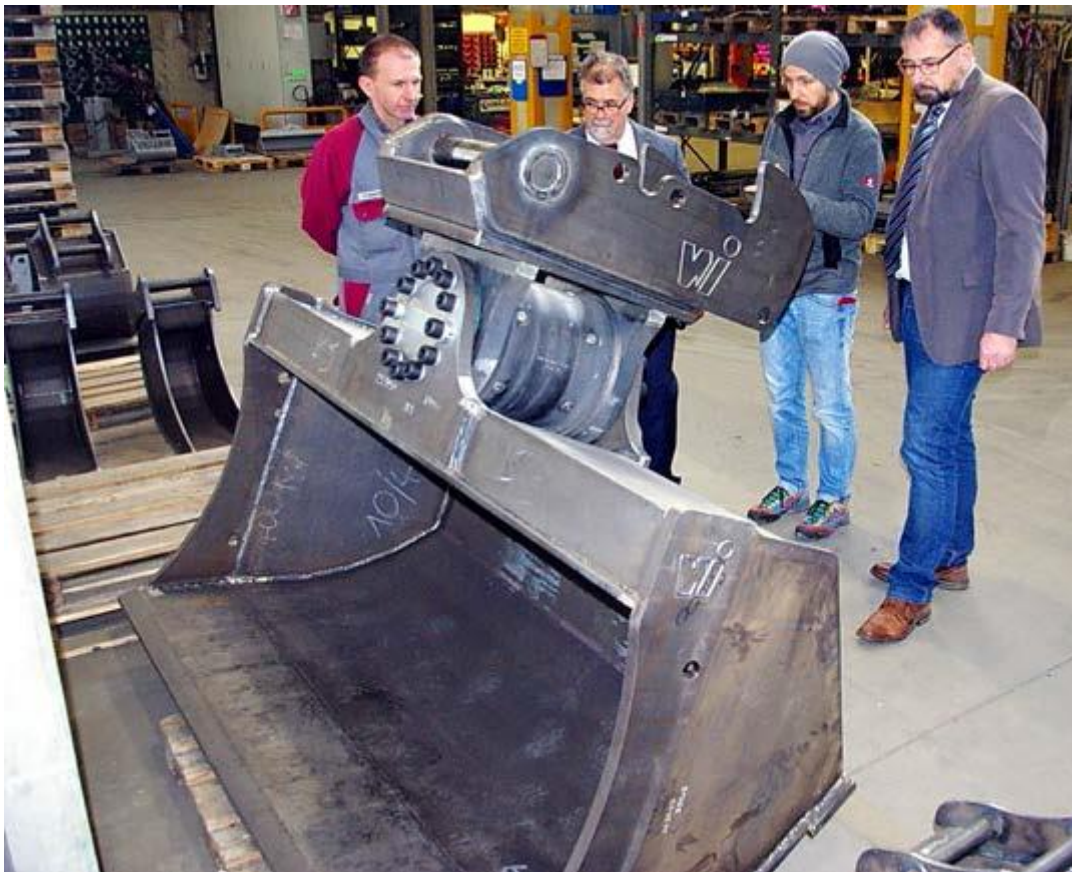
Herr Hörting (Winkelbauer), Herr Böhm (Ingersoll), Herr Portsch (Winkelbauer) und Herr Tammerl (Ingersoll) betrachten eine Baggerschaufel mit angebautem Adapter und besprechen weitere Werkzeugtests zur Optimierung der Hardox-Bearbeitung.
