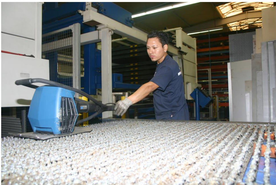
LST-Mitarbeiter Filiberto Dzul ist froh, die Schlacke nicht mehr mit dem Hammer entfernen zu müssen: „Mit dem Auflageleistenreiniger von TRUMPF geht das jetzt richtig schnell und gründlich.“
