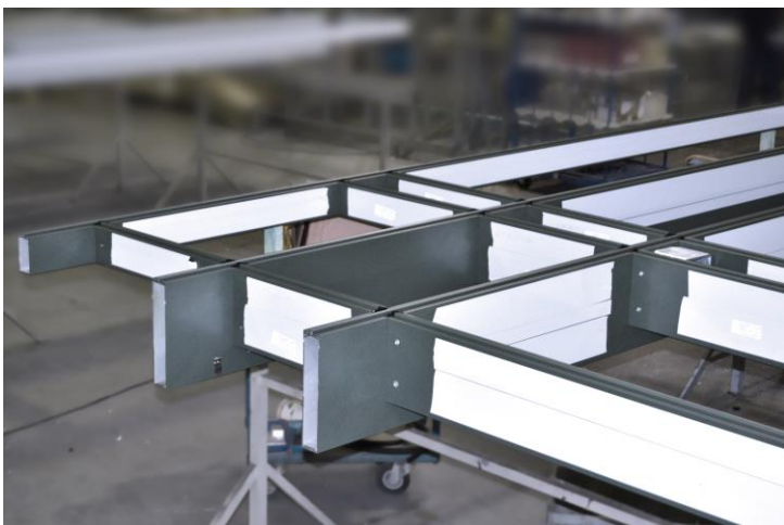
Pfosten-Riegel-Konstruktion in der Endmontage.
